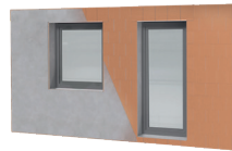
Ziegelfertigteile mit integrierter Lüftung, Fenster und Putz
